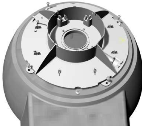
Abbildung 7: Schraubpunkte PION SPHERE Unterteil
